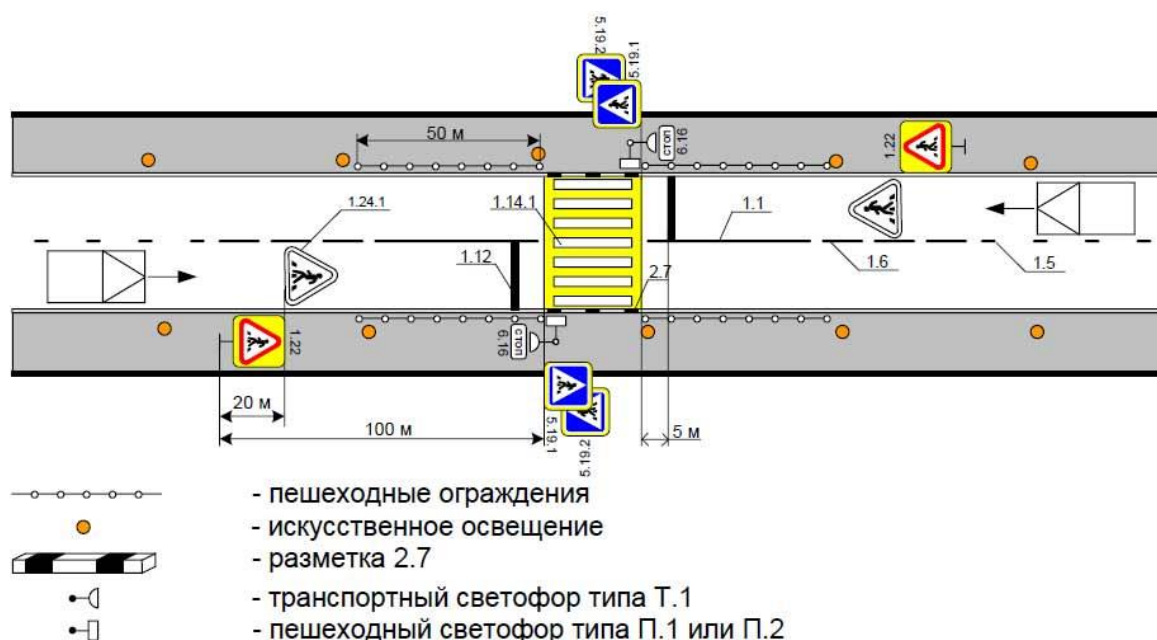
Рисунок 7 – Оборудование пешеходного перехода
